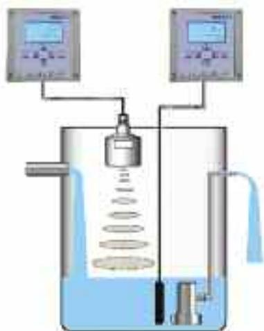
misura di livello ad ultrasuoni e piezometrica
