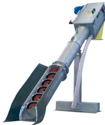
Questo tipo di apparecchiatura trova impiego nella separazione dei solidi grossolani da acque reflue di tipo civile ed industriale; l'acqua da trattare viene filtrata dal cestello filtrante che viene pulito in continuo da una coclea a spirale senza albero dotata di spazzola antiusura; i solidi trattenuti sono sollevati, compattati e scaricati tramite una coclea a spirale continua.
